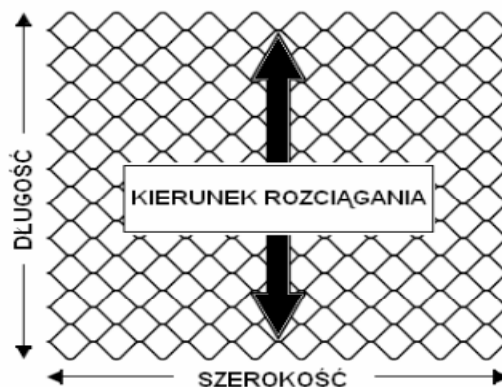
Rysunek 2 - Sekcja geosiatki komórkowej (geomaty) AB-Z - określanie kształtu i wymiarów.
